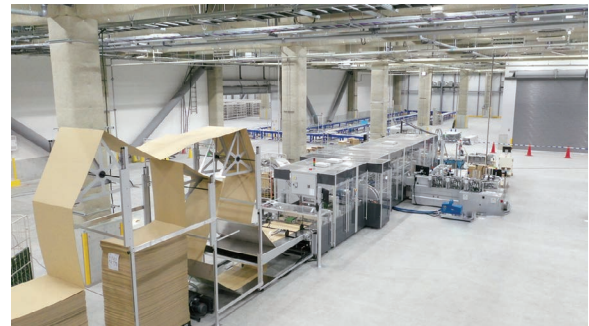
図表1-1-12 自動棚搬送ロボット（EVE）と自動梱包機（Carton Wrap）
