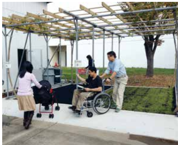
図表1-2-59 導入された路面緑化技術の開発段階におけるバリアフリー性能の確認状況
