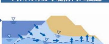
堤防の中の水位がさらに上がり、堤防が弱くなって崩壊しやすくなる
