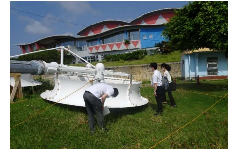
ホテル横の小型風車（写真は台風に備えて傾倒中）
