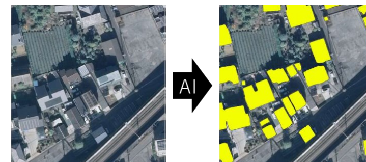
図1：衛星画像に対する建造物検出AI適用事例
