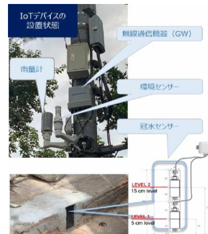
図2: 各種IoTセンサーを設置状態
