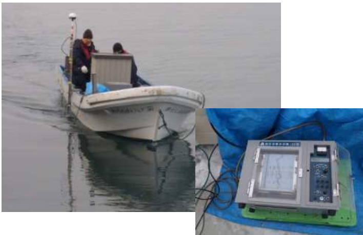
船舶を用いた音響測深機による測量
