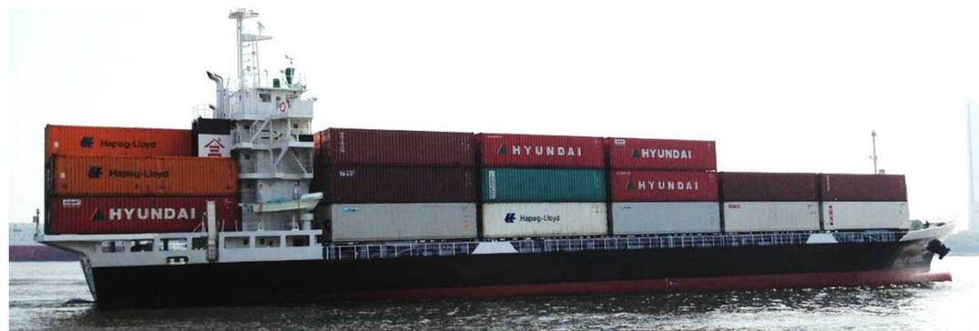
京浜港～北海道・東北航路に209TEU型の内航コンテナ船を投入したことにより、輸送能力が従前の最大2倍に向上(平成25年9月)。
