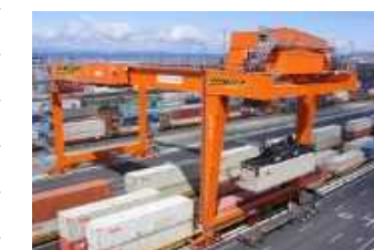
RMG(レール式トランスファークレーン)
