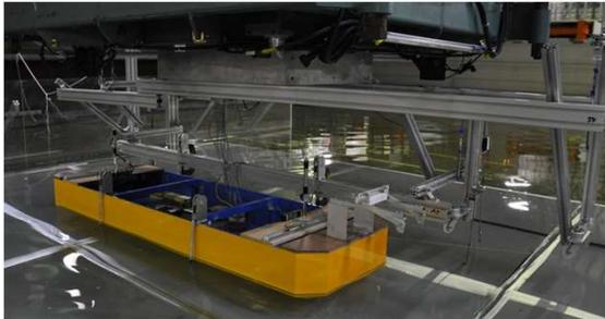
岸壁係船状態を模擬した模型試験
