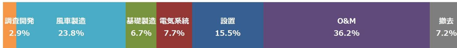
※数字(%)は「Guide to an offshore wind farm」(BVG associates, 2019)より三菱総研が算出したLCOEに占める割合
