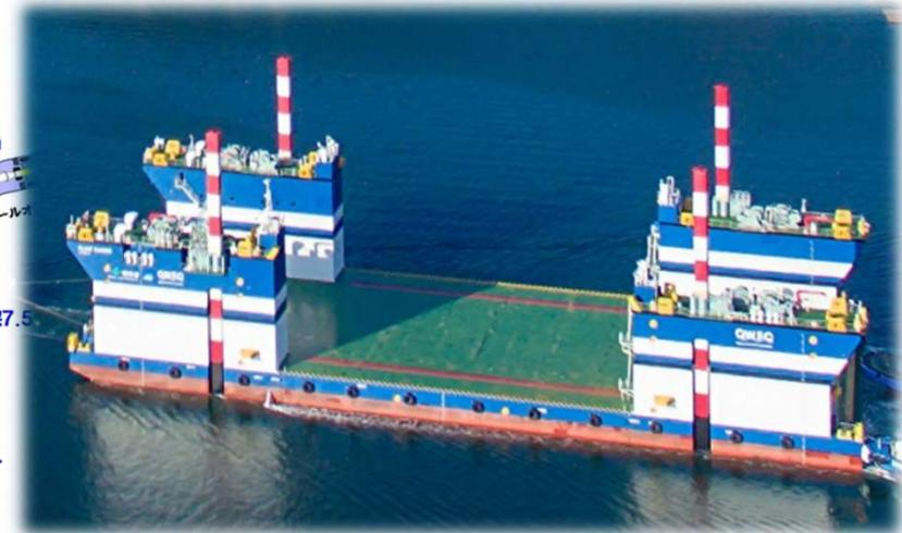
半潜水型スパッド台船「フロートレイザー」
