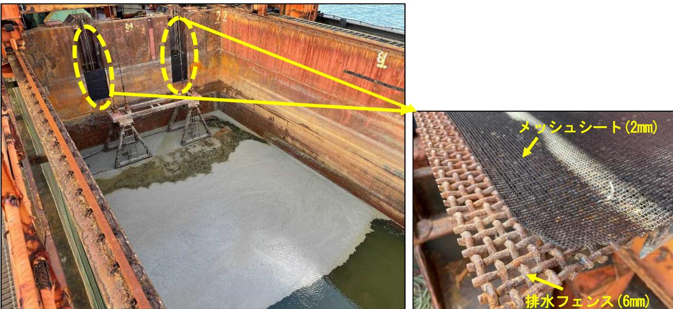
参考写真④：ストレーナーへの軽石付着状況
