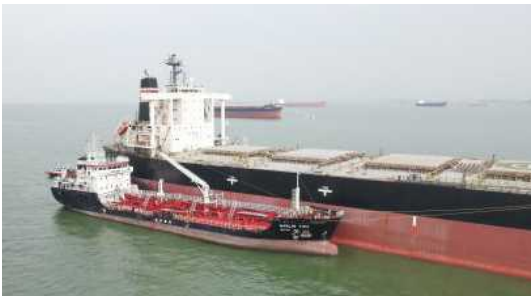
バイオ燃料の供給を受けた「Frontier Jacaranda」 (日本郵船、全長292m、総トン93,288トン、載貨トン182,757トン) 供給を行った「Marlin Tiga」(豊田通商ペトロリアム) (出典) 日本郵船プレスリリース2021.06.29 豊田通商プレスリリース2021.06.29
