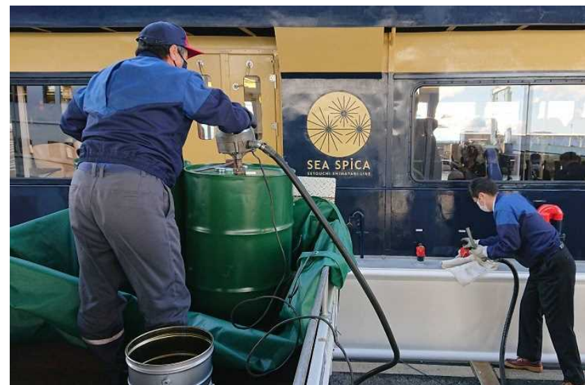
バイオ燃料「サステオ*」給油状況
