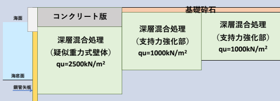
10MW風車対応疑似重力式断面
