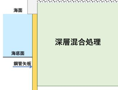
深層混合処理:  $qu=2500\text{kN/m}^2$
