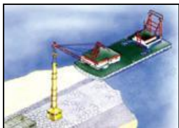
捨石投入・均し
