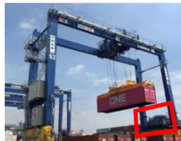
ディーゼルエンジンをFCへと換装し、水素を燃料とすることが可能
