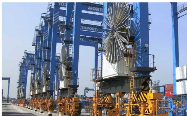
電動化（ケーブルリール方式）RTG （Cavotec HPより）
