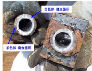
亀裂配管部断面確認
