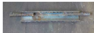
写真-3 落下した架台部材
