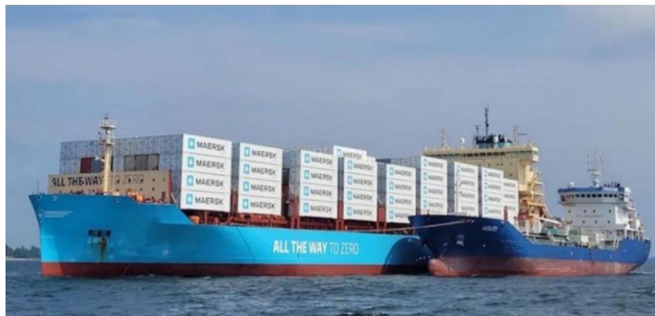
マースク社のグリーンメタノールバンカリングの様子 (2023年7月 シンガポール港)
