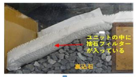
分解安定型フィルター工法の 小型検証実験
