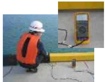
写真 3-3.2 電位測定状況
