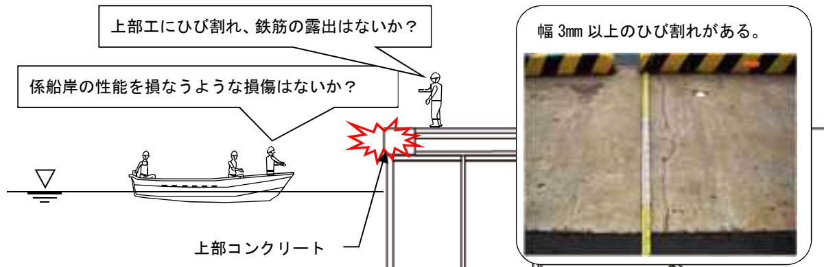
図 3-2.4 上部工の点検状況
