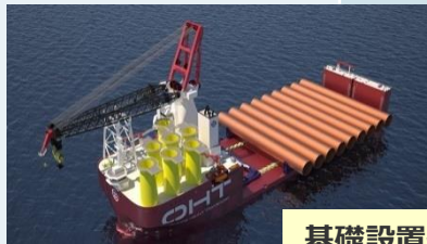
基礎設置船(FFIV) ※着床式のみ
