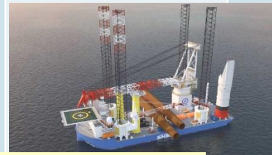
風車設置船(SEP船)
