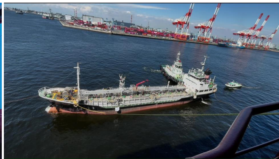
タグボート、綱取りボートによりサポートを受けながら接舷及び係留索をALETTE MAERSKへ渡す様子
