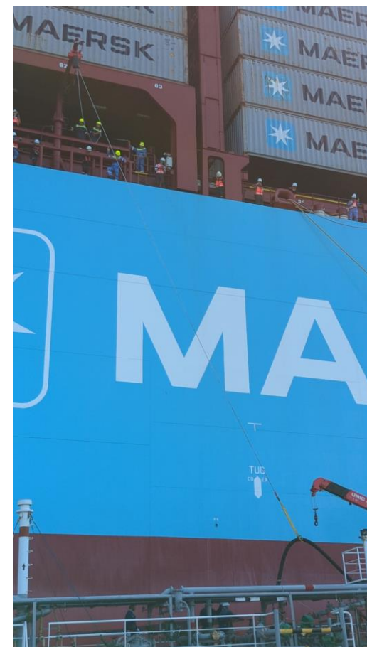
ALETTE MAERSKバンカーステーション備え付けクレーンによるホース引き上げの様子
