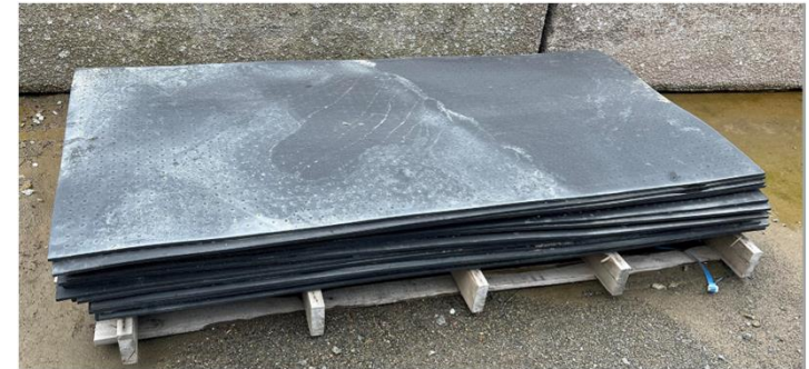
仮設係船柱の下に敷設したゴムマット（摩擦増大のため）
