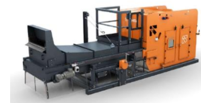
金属高度選別設備
