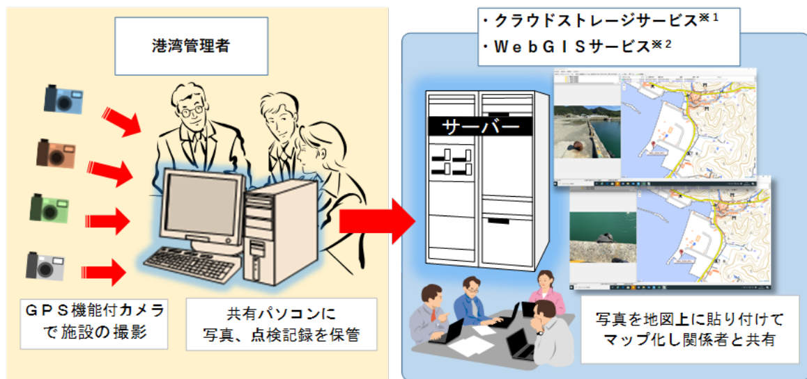
図－１ 写真データ共有の流れ
