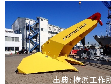
ストックレス (ドラッグアンカー) の例
