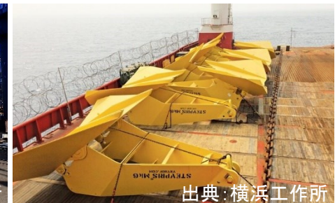
ストックレス (ドラッグアンカー) の例
