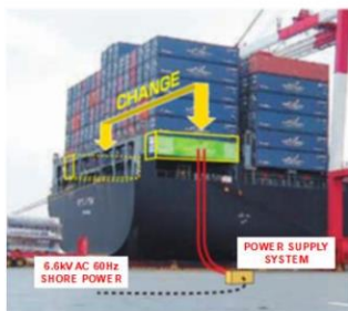
停泊中船舶への 陸上電力供給
