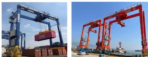
水素燃料電池(FC)換装型RTG
