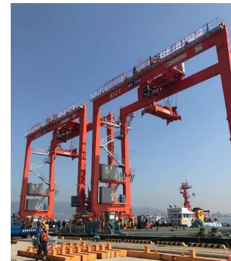
RTGの水素燃料化実証
