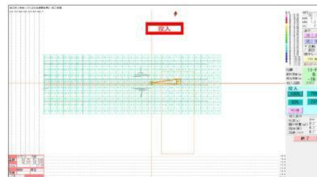
捨石投入支援装置による誘導画面
