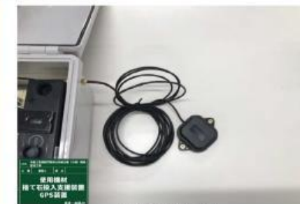
GNSS外部アンテナ
