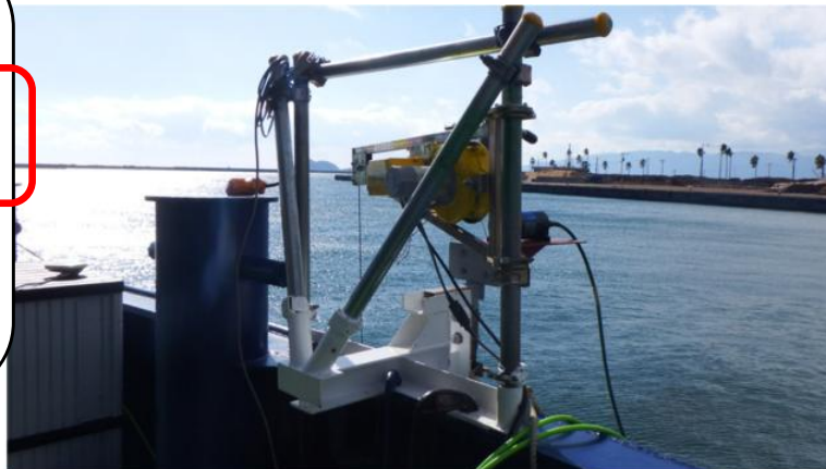
ソナーシャフト設置架台
