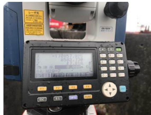
TSによるGNSSアンテナ位置の計測状況
