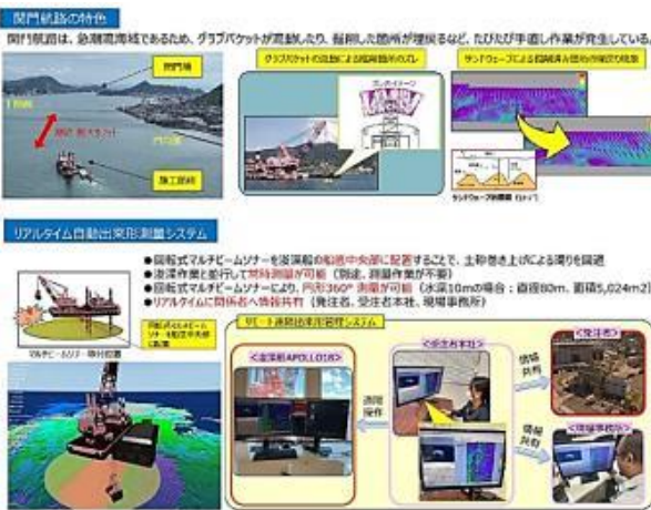
音響ソナーの活用による浚渫工事の施工管理の省人化
