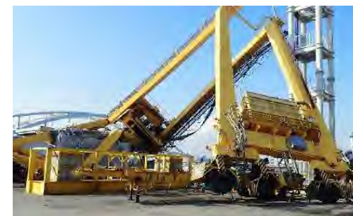
強風によるクレーン損壊
