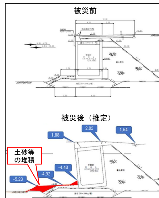
被災前後の断面図(-4.5m岸壁)
