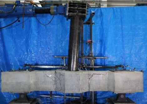
交番载荷試験の状況
