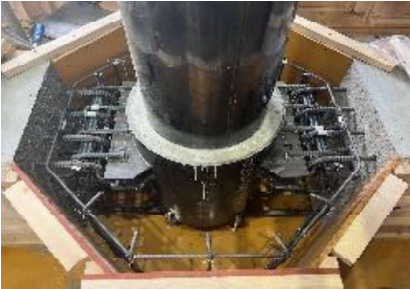
杭頭部の構造 （イメージ図：上、交番载荷試験体：下）
