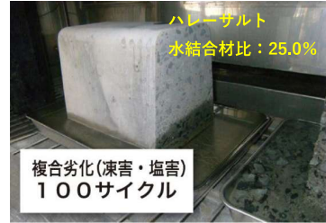
複合劣化に対する抵抗性確認試験（ハレーサルト）
