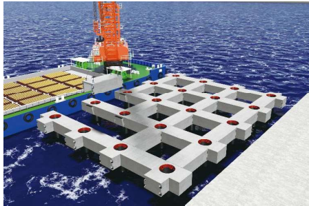
梁部材の架設状況
