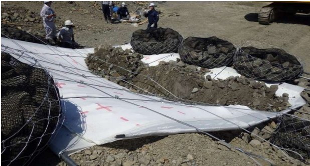
陸上での実物大による実証実験(2) － 高強度多重布 －
