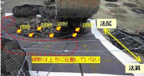
陸上での実物大による実証実験(1) － 長繊維不織布(最小規格) －
