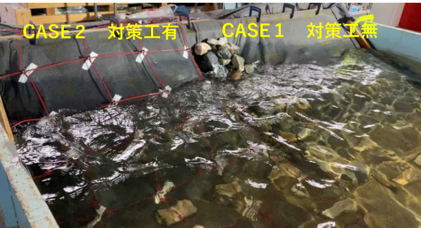
防砂シート引込軽減工法によるフラッターリング損傷防止効果確認実験 － 長繊維不織布(最小規格) －
