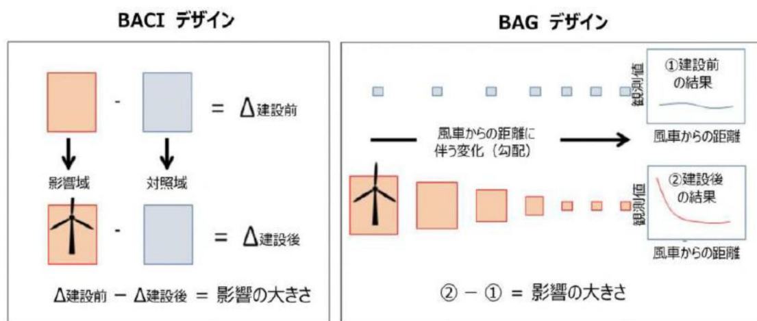
図3. 風車等の設置位置からの距離に伴う変化の調査結果から影響の大きさを求めるモニタリング調査方法（BACI デザイン, BAG デザイン）のイメージ（Secor, 2018 を一部改変）
