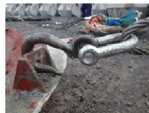
使用していた吊りフック (外れ止め無し)
