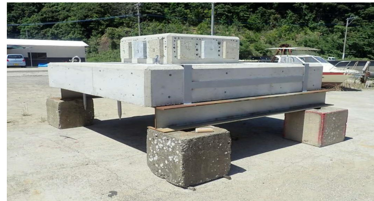
野外実験用の構造物の写真(江島 沿岸に沈設しモニタリングを継続)
