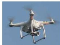
UAV(ドローン等)による3次元測量
