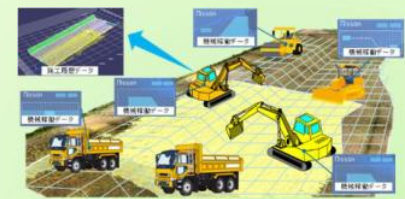
建設機械施工の自動化
