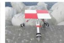
レーザ測量用対空標識
