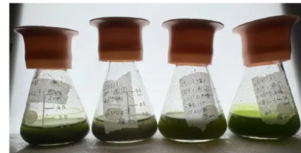
有機物を含んだ土砂を藻類微生物で浄化する実験の様子 出典:静岡大学農学部准教授 長尾遼
