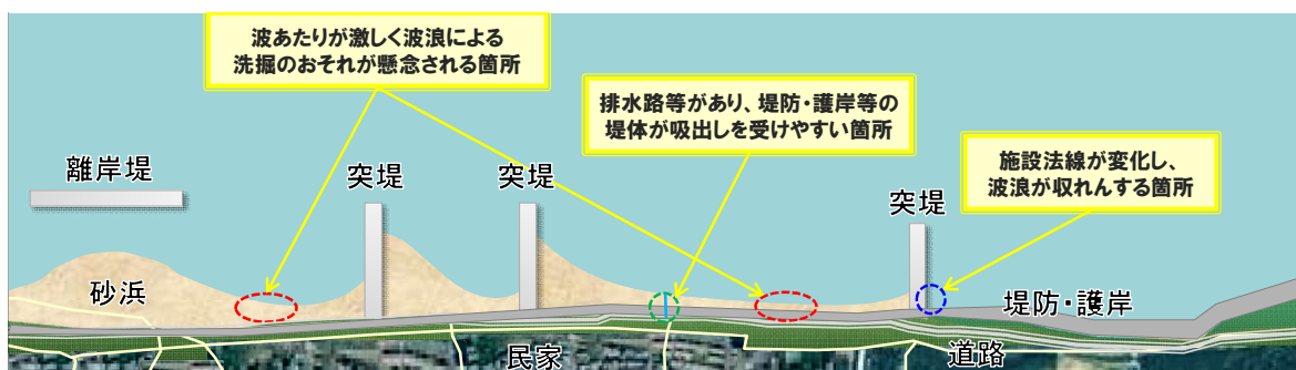
図-2.1 地形等により劣化や被災による変状が起こりやすい箇所（重点点検箇所）のイメージ
