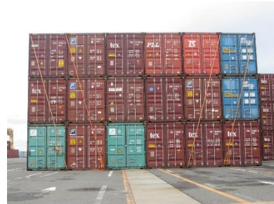
写真 3.2.4 ラッシングベルトによる固定
