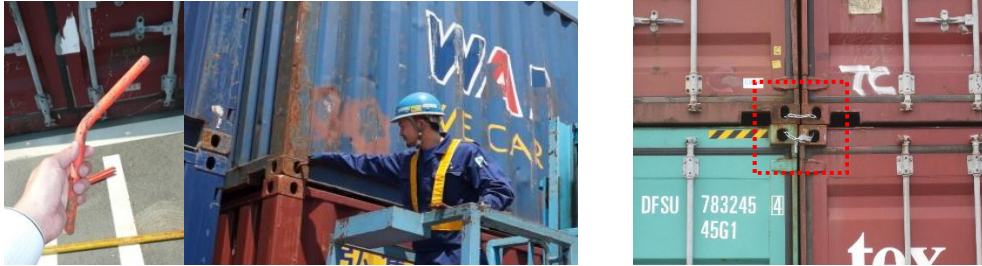
写真 3.2.1 コンテナ同士の固定（左：金具（ブーメラン）、右：チェーン）
