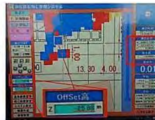
施工管理システムにおけるオフセット値の表示例
