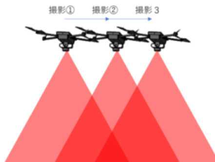
インターバル撮影：シャッターを一定間隔で切る機能 飛行速度・対地高度によりシャッター間隔は変化する
