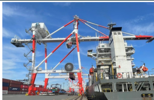
インバーター制御方式のガントリークレーンの導入 (供用開始した新1号機)
