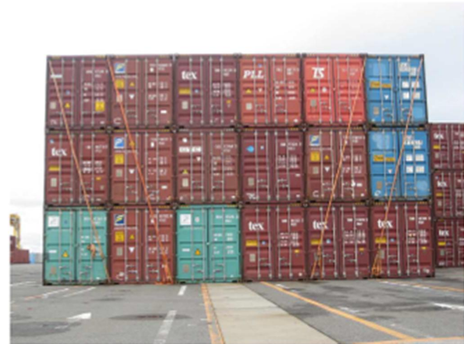
写真 ラッシングベルトによる固定
