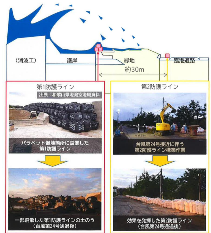
図 和歌山下津港の土のう配置例
