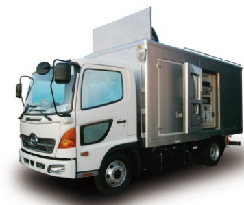
電源車 (出典：明電舎HP)
