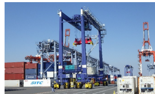
遠隔操作RTG
